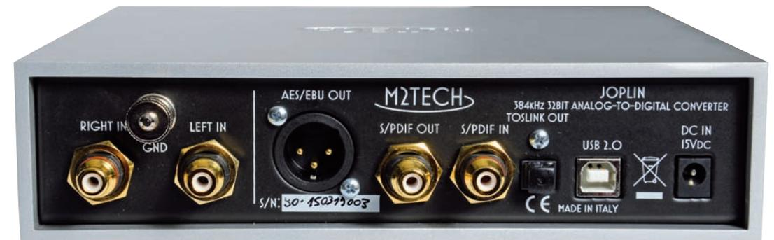
L'analogique (phono ou ligne) entre par les cinch situées à gauche. Après la conversion analogique vers numérique, le signal est disponible sur les sorties AES, S/PDIF coaxiale et optique, de même que sur le port USB.
